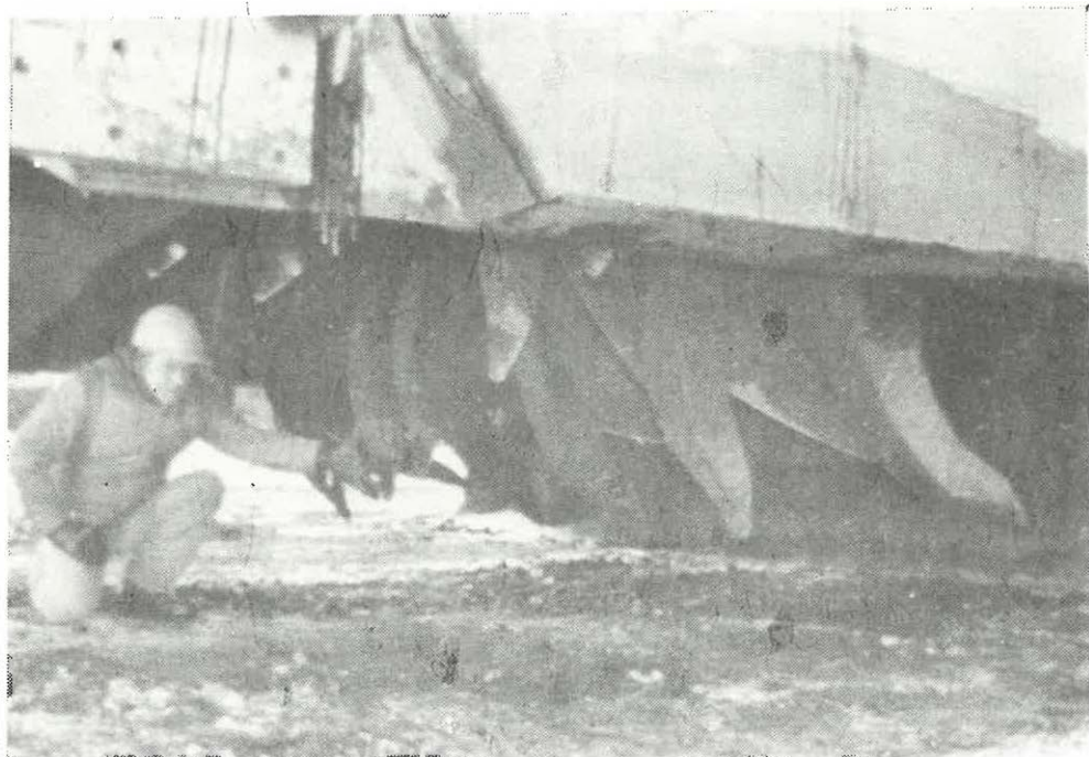
OBR. 4 - Pohled na dobyvací orgán rypadla Easi-Miner, model 1224, znázorněného na obr. 5, obr. 6
