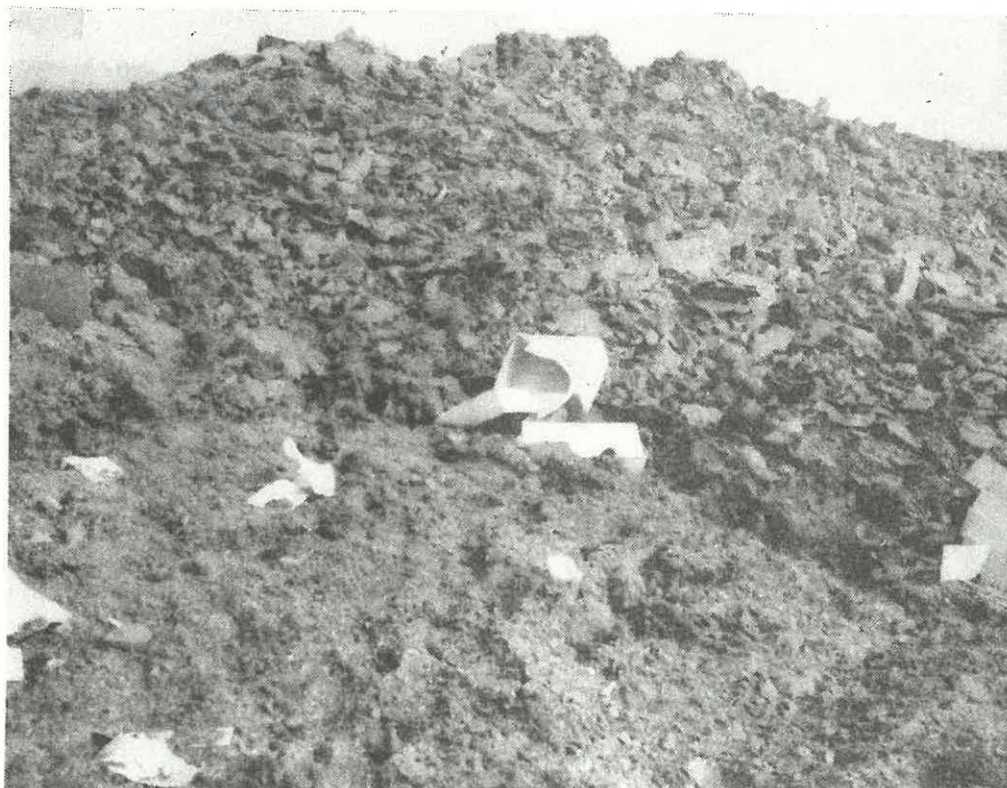
Nakypření a fragmentace u odstřelu s trhavinou Emsit, zvětšené rozteče.
