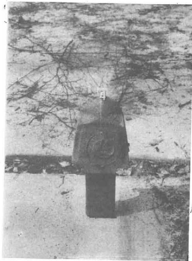
obr.15 Zub v.č.5559 - po odstřelu vrstvy 6 mm - povrchová licí vada
