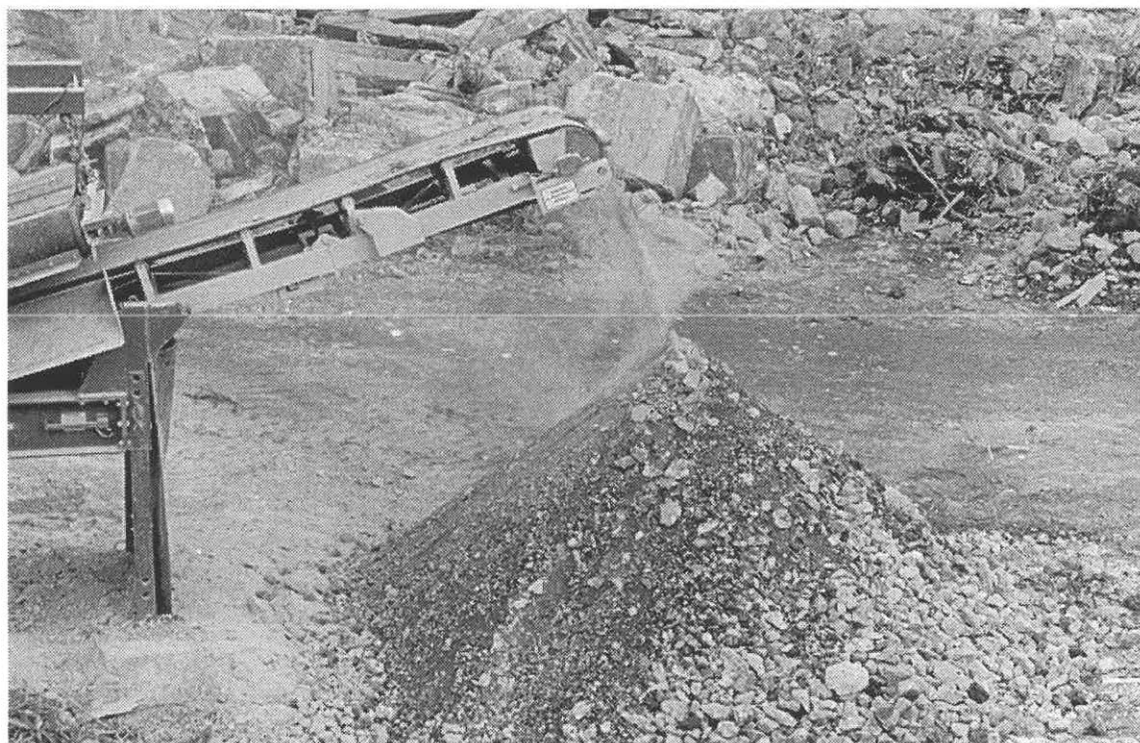
Obr. 2 Rozdrcený materiál je směrován na pásový dopravník a sypán na deponii
