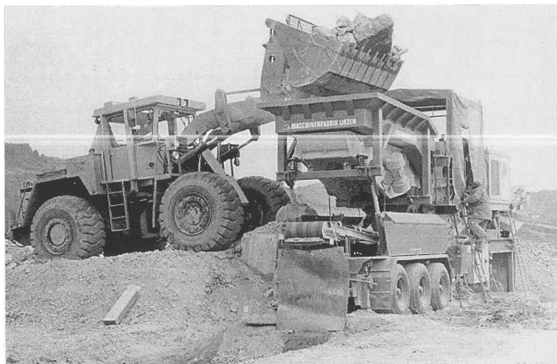
Obr. 3 Plnění drtiče odpadem zajistí i běžný kolový nakladač
