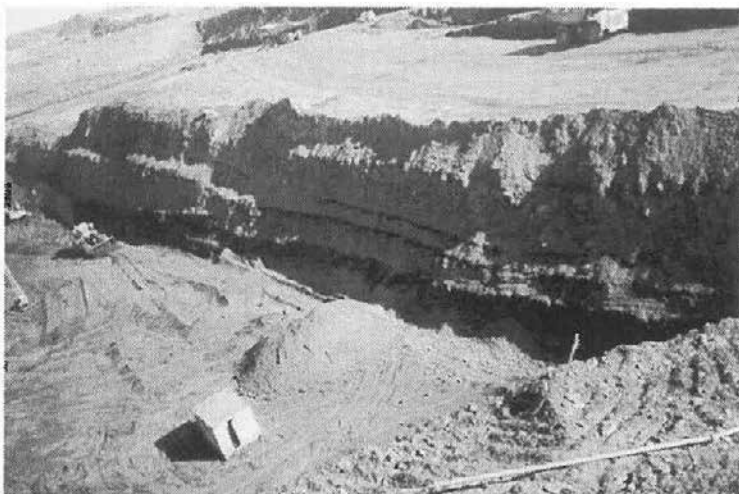
Obr. 2 Pohled na uhelné souvrství v porubní frontě povrchového dolu Ffos Las v Jižním Walesu. Těží se uhelné vrstvy do 10 cm. V levém horním rohu staré haldy původní hlubinné těžby.
