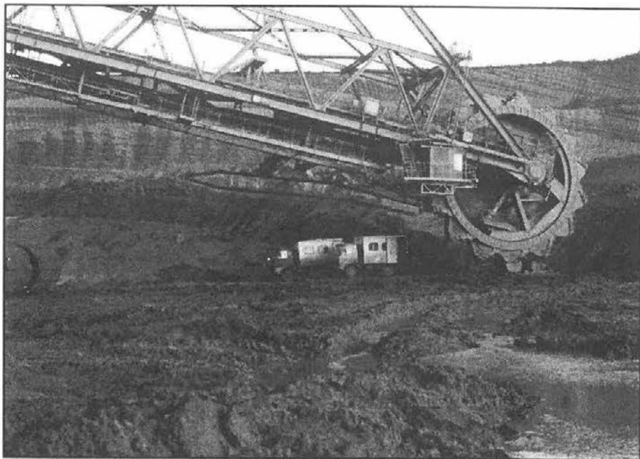
Obr. 10 Pískovcová čočka mocnosti nad 1 m znemožňuje rýpadlu K 2000 postup spodní dobývací lávky
