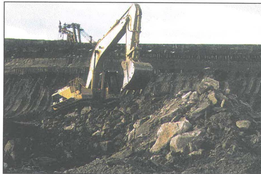
Obr. 13 Dobývání pískovcových kvádrů pomocí hydraulického rýpadla
