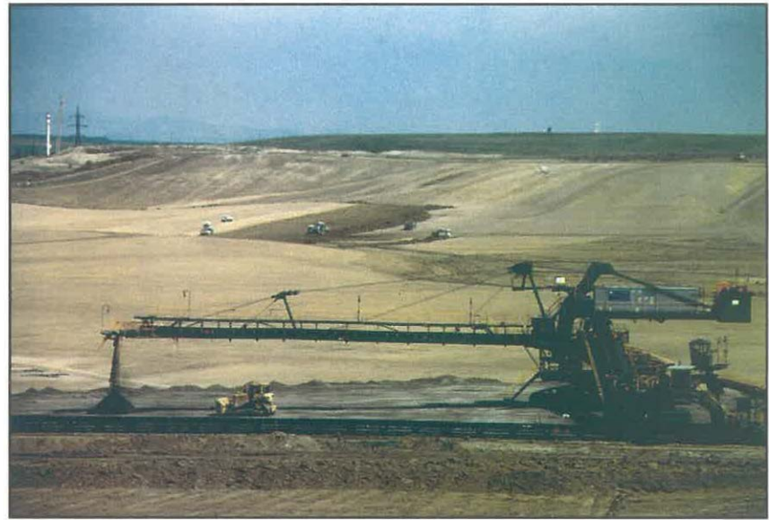
Obr. 4 Detailní záběr na pásový zakladač při ukládání první vrstvy upraveného popílku na tuto skládku - pro její provoz byla rovněž vybrána část výsypky lomu Libouš
