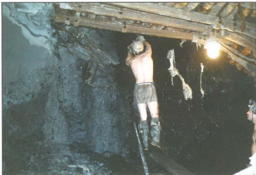
Obr. 1 Znáznornění vrtání a injektáž PUR pryskyřicí
