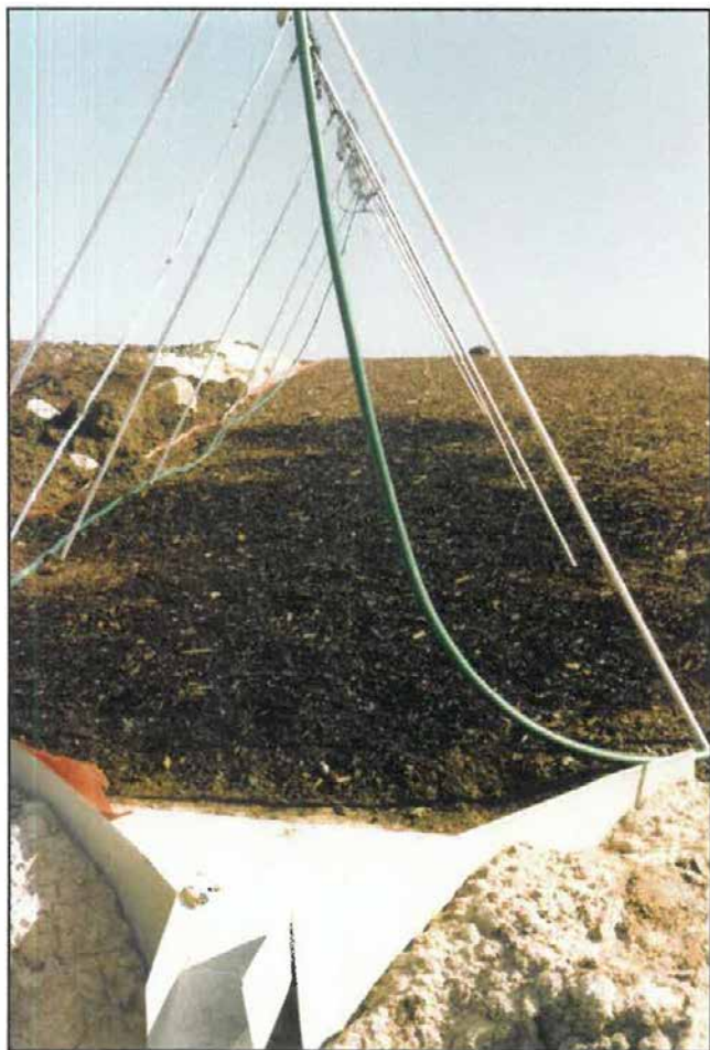
Testování povrchu výsypky rekultivovaného mulčem z kůrových kompostů pomocí simulátoru deště
