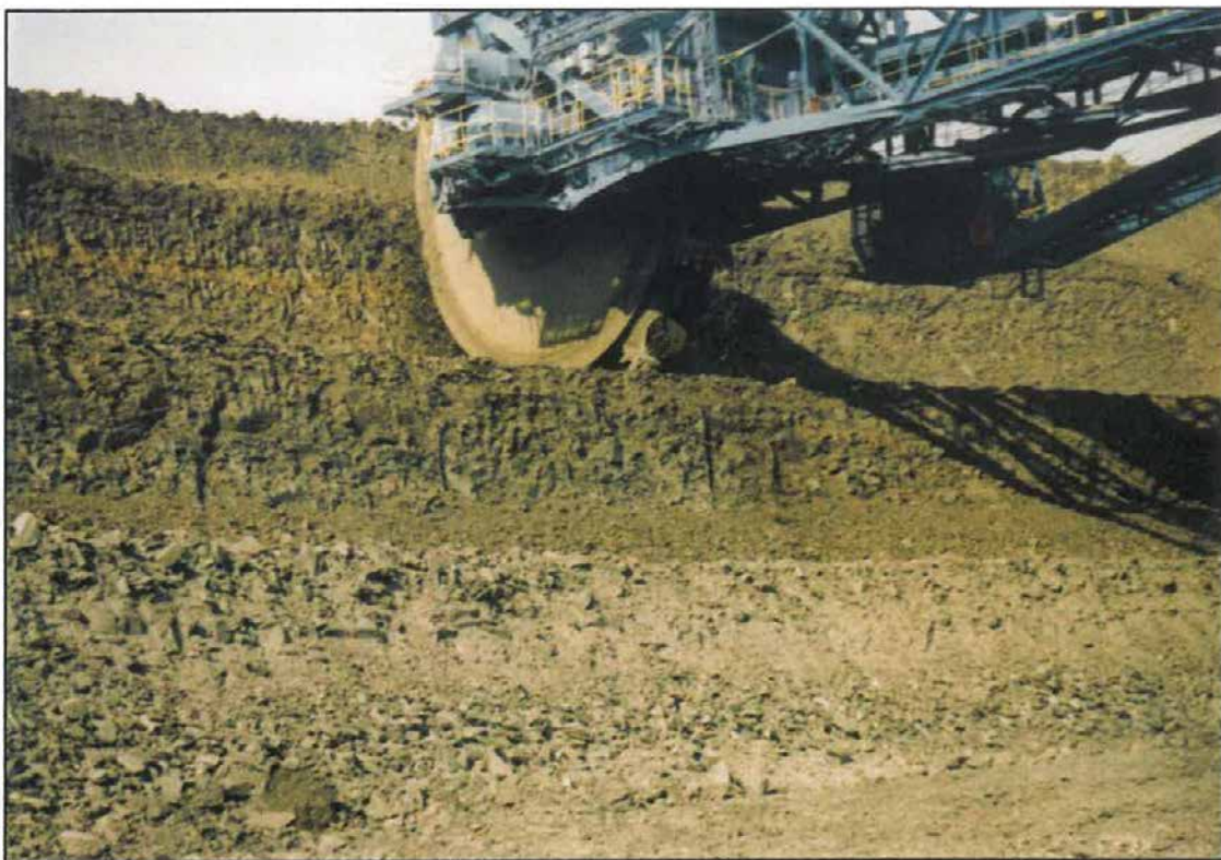
Obr. 4 Horninový masiv I. skryvkového řezu dobývaný rýpadlem SRs 1500
