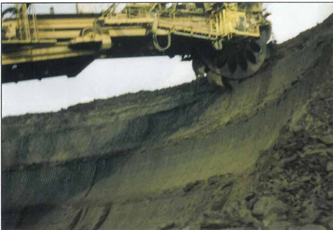
Obr. 5 Horninový masiv IV. skryvkového řezu dobývaný rýpadlem KU 800
