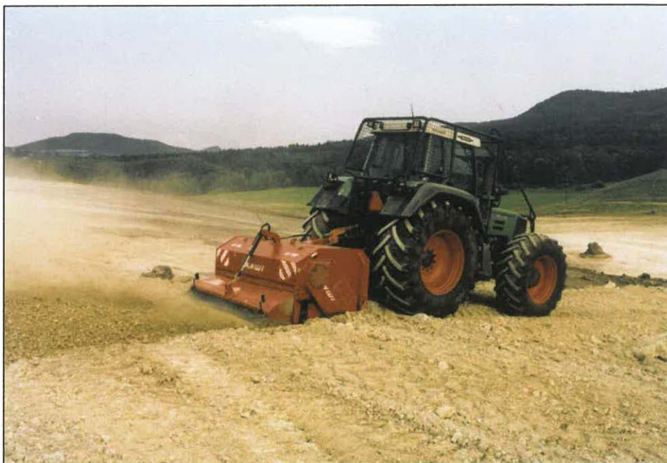
Obr. 1 Mulčovací fréza AHWI na výsypce Radovesice
