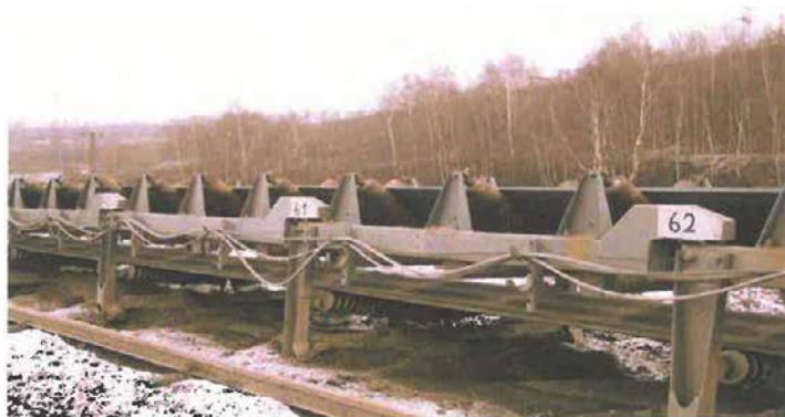
Obr. 1 Očíslování středních dílů pásového dopravníku
