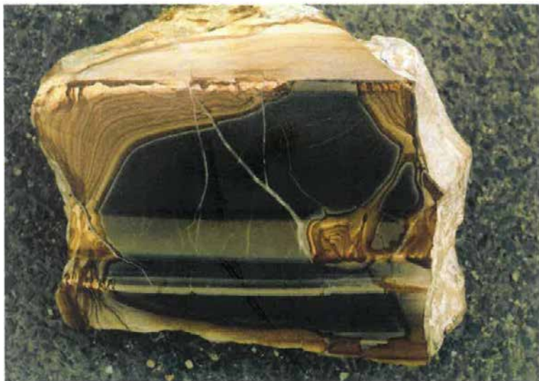
Obr. 2 Naleštěný nábrus dolomitového slínu (rozměry vzorku 16 x 12 cm)
