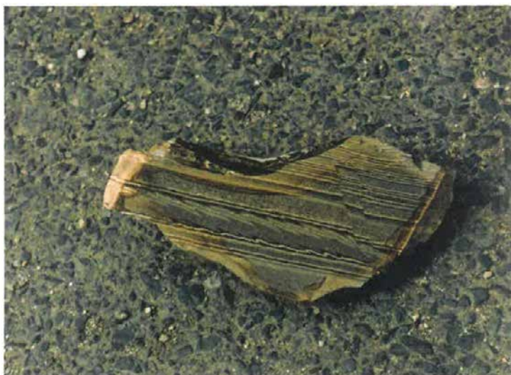
Obr. 2 Naleštěný nábrus dolomitového slínu (rozměry vzorku 16 x 12 cm)
