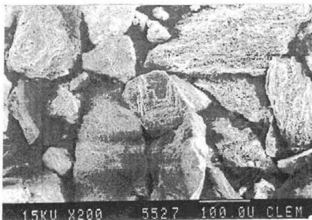
Obr. 3 Morfológia čiernouhoľného popola z fluidného kotla zo závodu Energetika Třinec (200 násobné zväčšenie)
