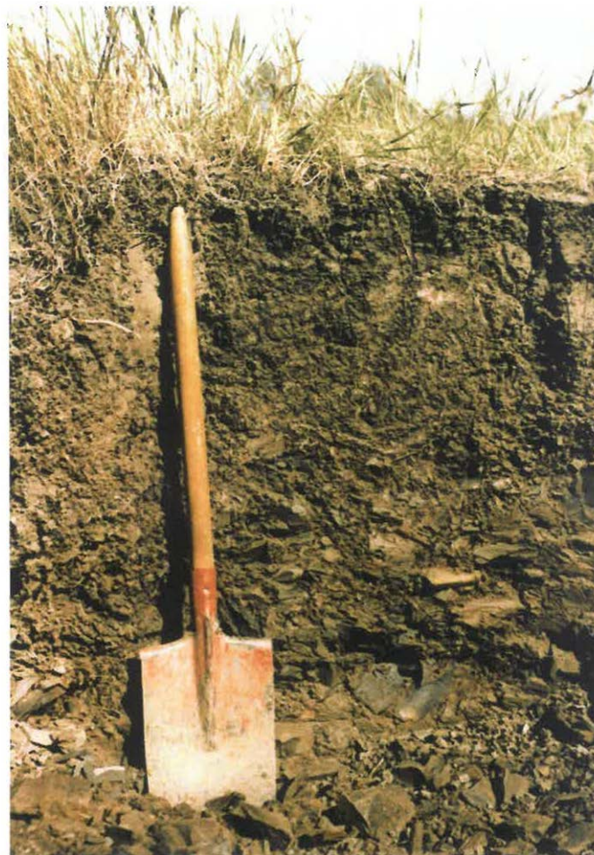
Obr. 2 Výsypka Horní Jiřetín – zemědělská rekultivace, přímá rekultivace trciérních jílu půdní typ: antropozem
