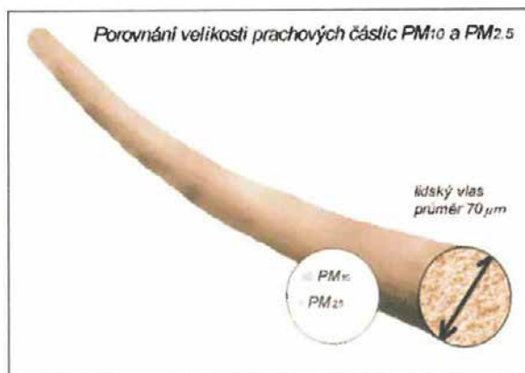
Obr. 1 Porovnání velikosti prachových částic PM_{10} a PM_{2,5}
