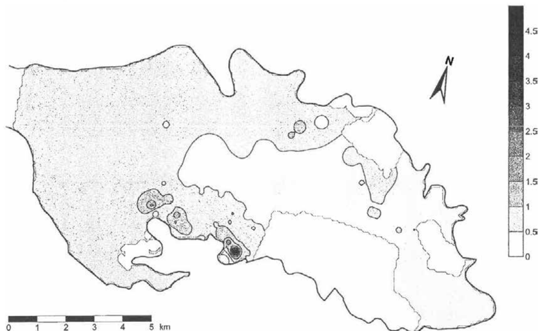
Obr. 7 Distribuce síry ve spodní lávce uhelné sloje (3)
