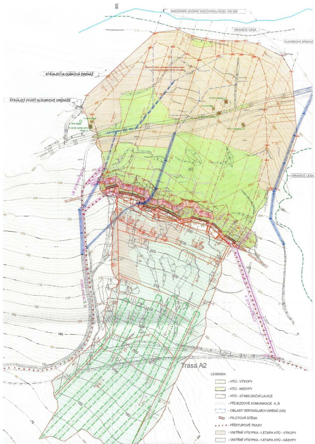
Obr. 3 – Celková situace sanačních prvků svahu RABENOV
