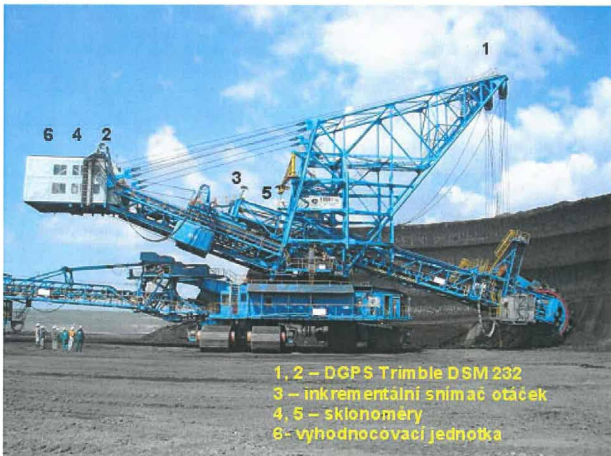
Obr.1. Rozmístění GPS a inerciálních snímačů na rýpadle K800/103/N1
