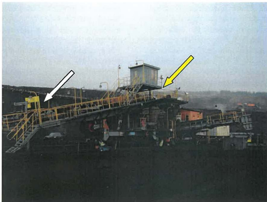
Obr. 6 - Shazovací vůz SV12 – žlutá šipka vyznačuje původní umístění popeloměru, bílá popeloměr po přemístění
