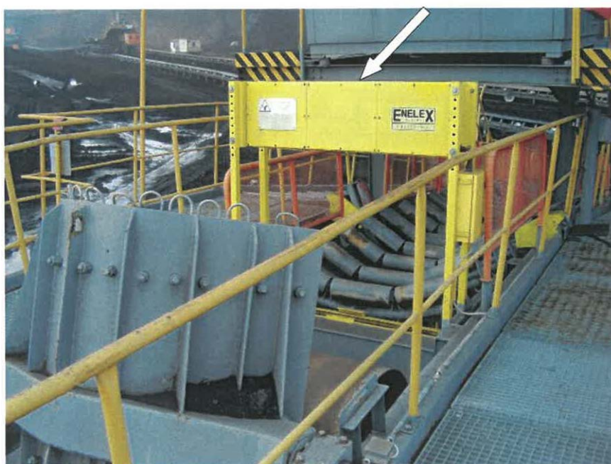
Obr.5 - Původní umístění popeloměru Enelex u přesypu shazovacího vozu
