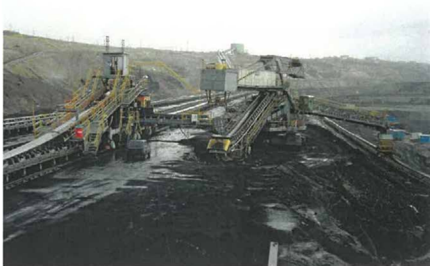
Obr.8 - Nové nasazení shazovacího vozu SV 22 ve spojení s PVZ 2500/103
