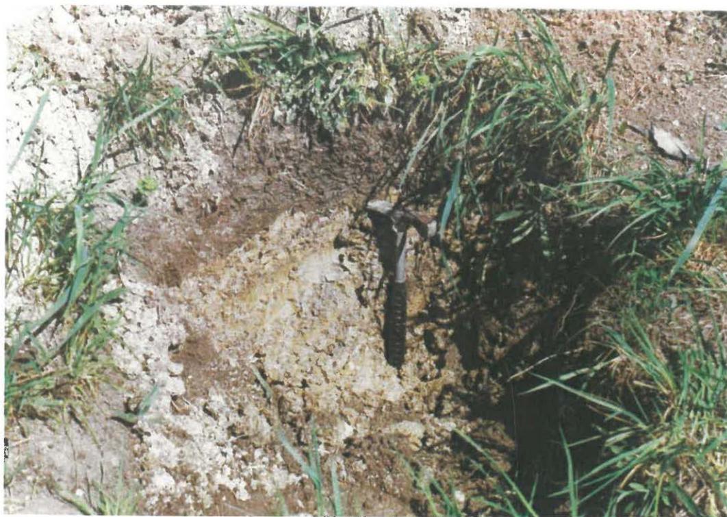
Obr. 2 - Antropogenní půdní profil na pokusné ploše Radovesice III (aplikace slínu)
