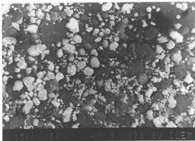
Obr. 1 - Morfológia granulačného popolčeka z roku 2005 - zväčšenie 54 x
