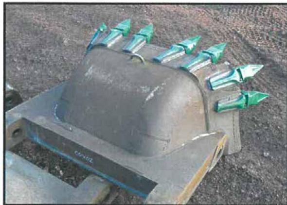
Obr. 2 – Koreček osazený zuby ESCO
