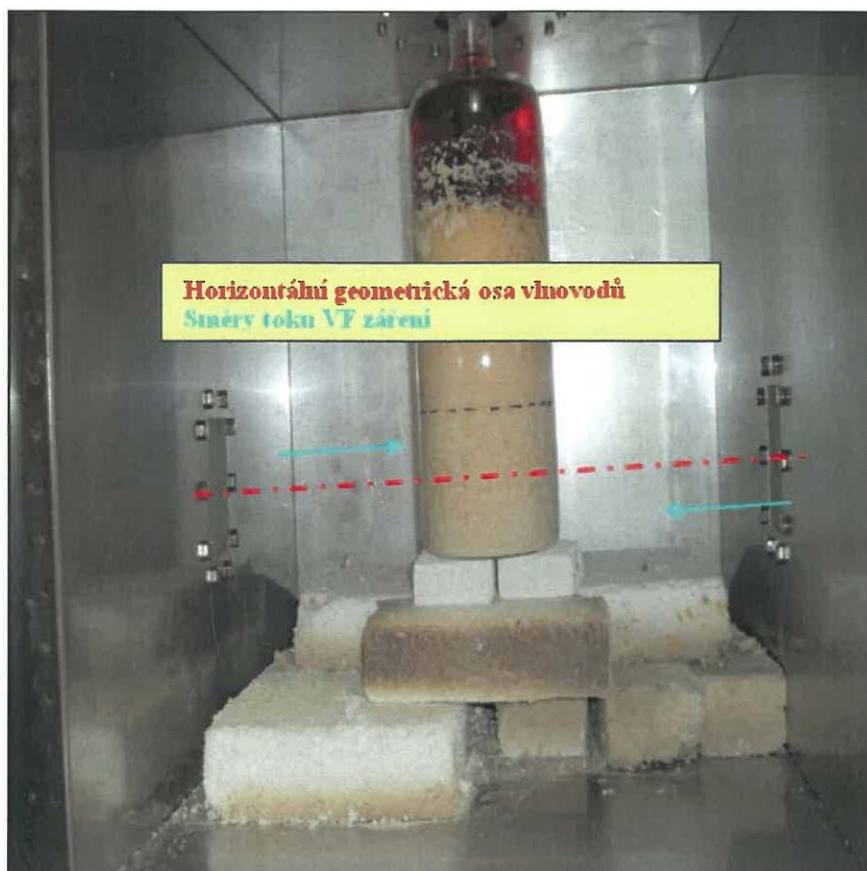
Obr. č. 2 – Geometrie optimálního uspořádání VF rozkladu PET pro danou konstrukci experimentálního zařízení
