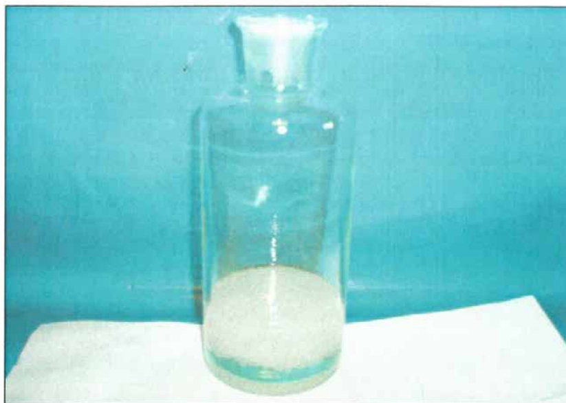
Obr. č.4 – Plovoucí „spečená“ vrstva jemnozrnného PET, zrnitost zatěžkávadla 0 – 0,5 mm
