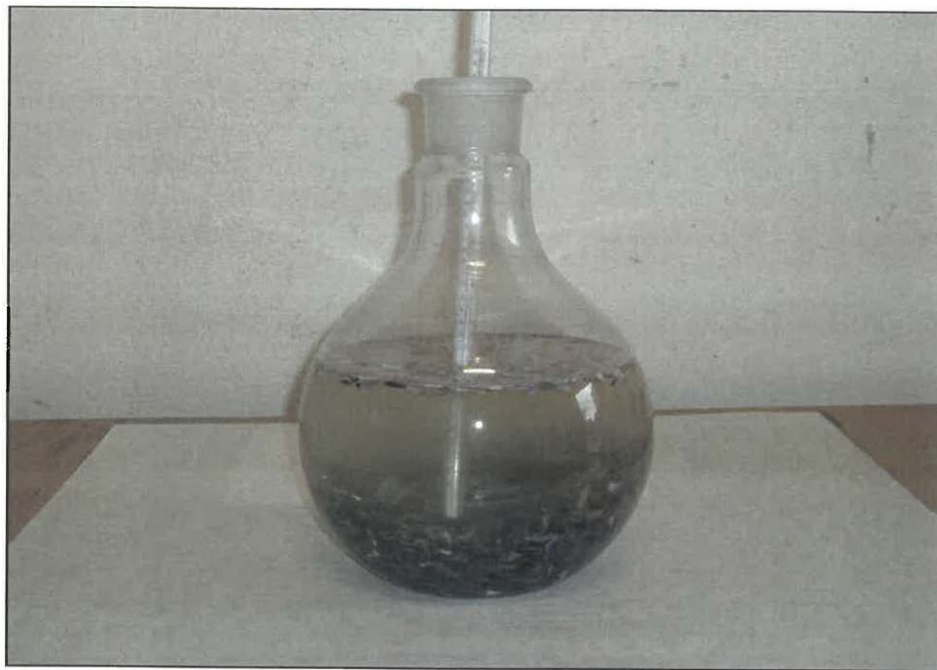
Obr. č. 3 – Samorozdružovací efekt v suspenzi PET, zrnitost zatěžkávadla 0 – 30 mm
