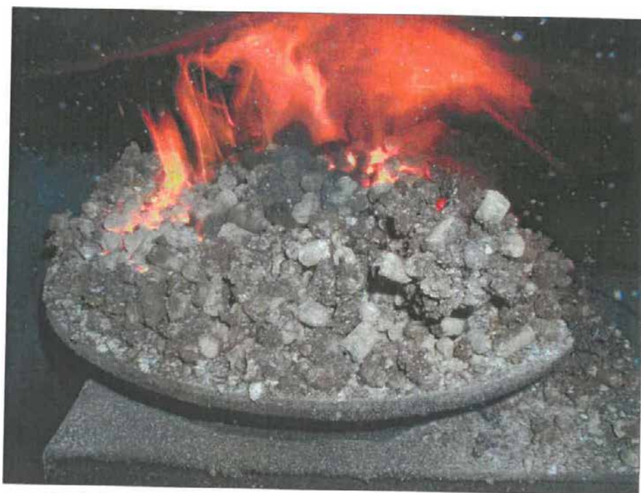
Obr. 1: Spalování paliva podle receptury R5 ve spalovací komoře kotle Ling 25
