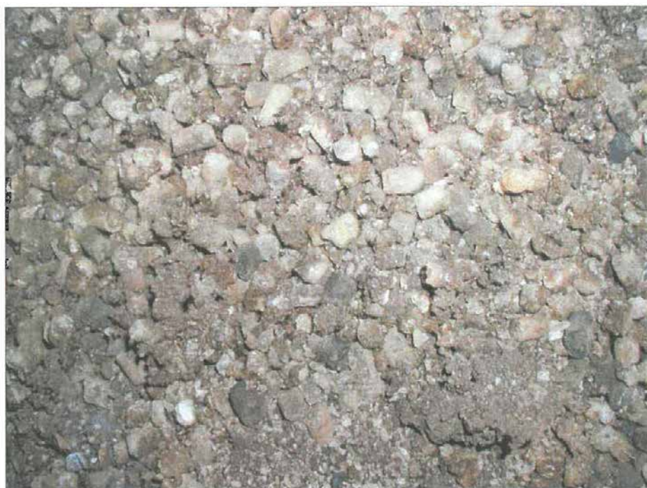
Obr. 2: Popel po spalovací zkoušce paliva připraveného dle receptury R5
