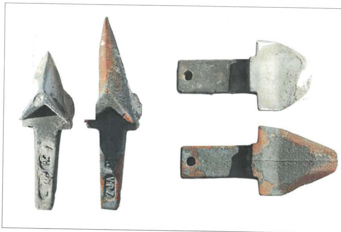
Obr. 7: Příklad opotřebení zubu
