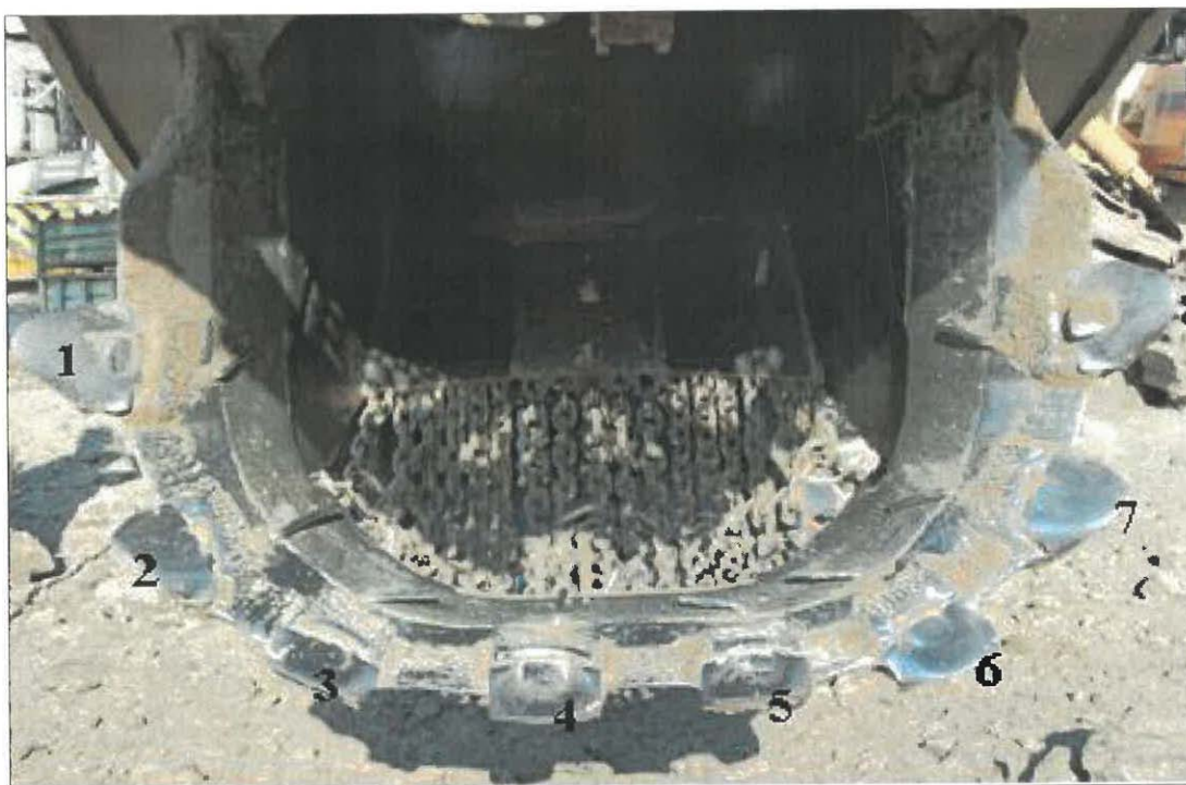
Obr. 6: Přehledné označení pozice zubů na korečku velkostroje
