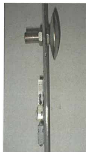
Obr. 2: Provzdušňovací element a tenzometr
