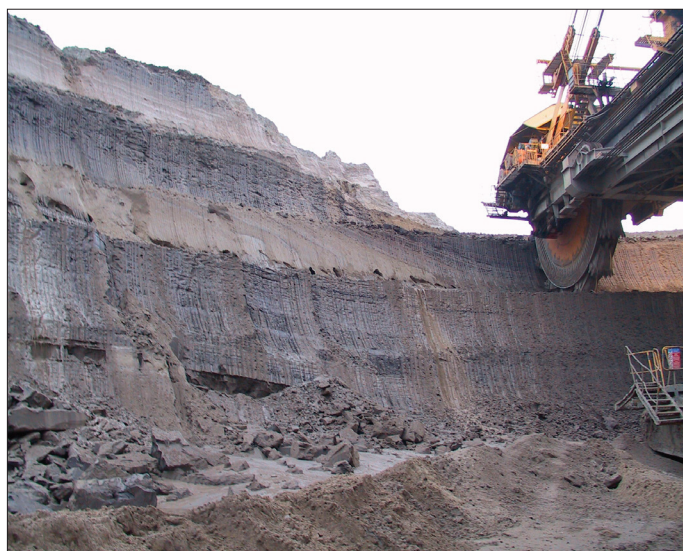
Obr. 5: Kuřavkou zaplavená část plošiny u rýpadla K-65, lom Bílina. Foto: K. Mach.
