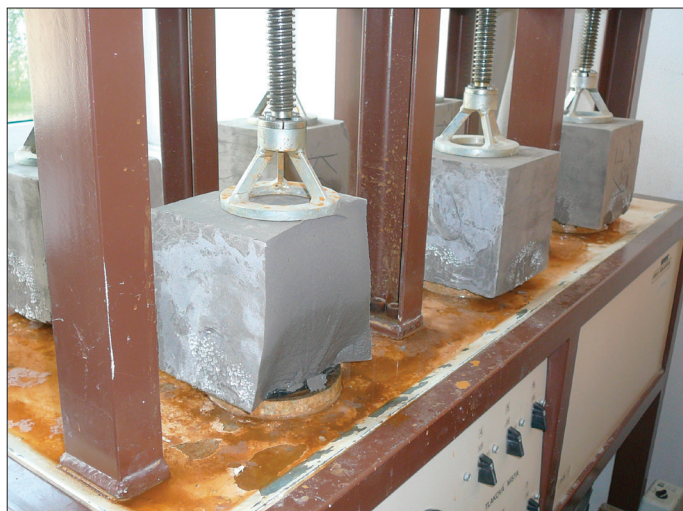
Obr. 3: Znárodné průsaky na zkušebních krychlech směsi K5 a K10.
