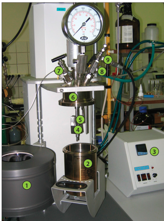
Obr. 1: Hydrogenační reaktor firmy PARR model 4520 a řídicí jednotka.
