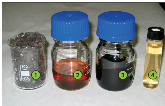
Obr. 3: Katalyzátor a produkty hydrogenace při tlaku vodíku 0,1 MPa.
