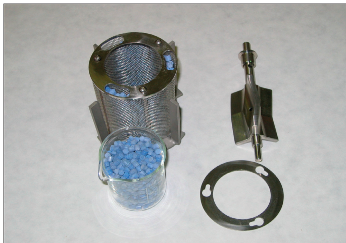
Obr. 2: Koš na katalyzátor; míchadlo a katalyzátor BASF 0852.
