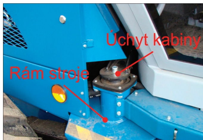
Obr. 2: Měřicí místa úchyty kabiny a rámu
