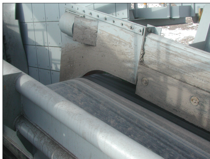
Obr. 1: Nerovnoměrné zatížení pásu na DPD
