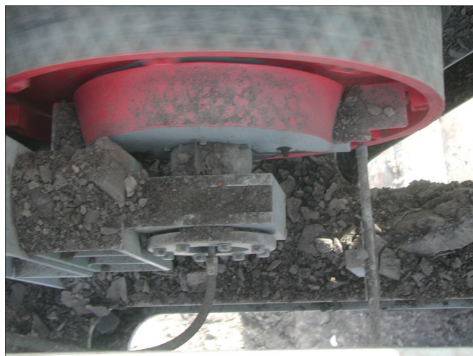
Obr. 2: Jedna strana bubnu vykazuje zvýšenou povrchovou teplotu
