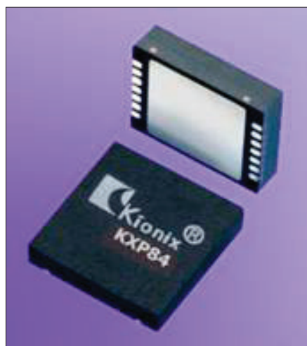
Obr. 1: Komerční MEMS akcelerometr (zvětšeno, plastové pouzdro 5 x 5 x 1,2 mm)
