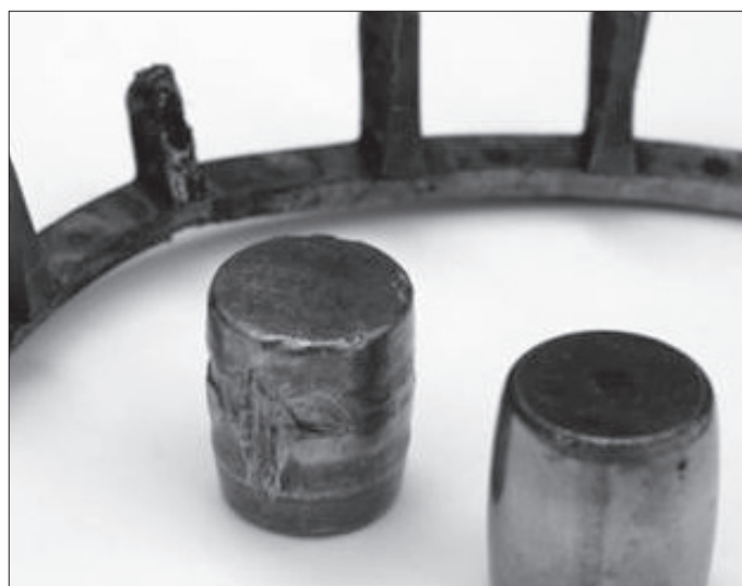
Obr. 8: Demontované válečky a poškozená klec ložiska
