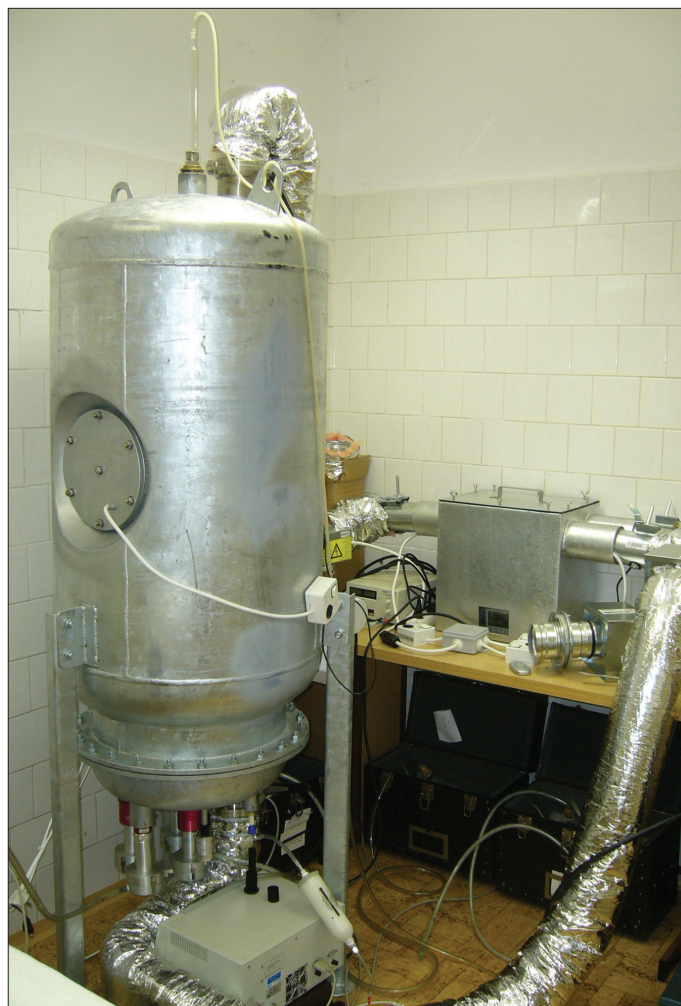
Obr. 1: Resuspenzní komora v Laboratoři pro měření kvality ovzduší na Ústavu pro životní prostředí, PřF UK v Praze.
