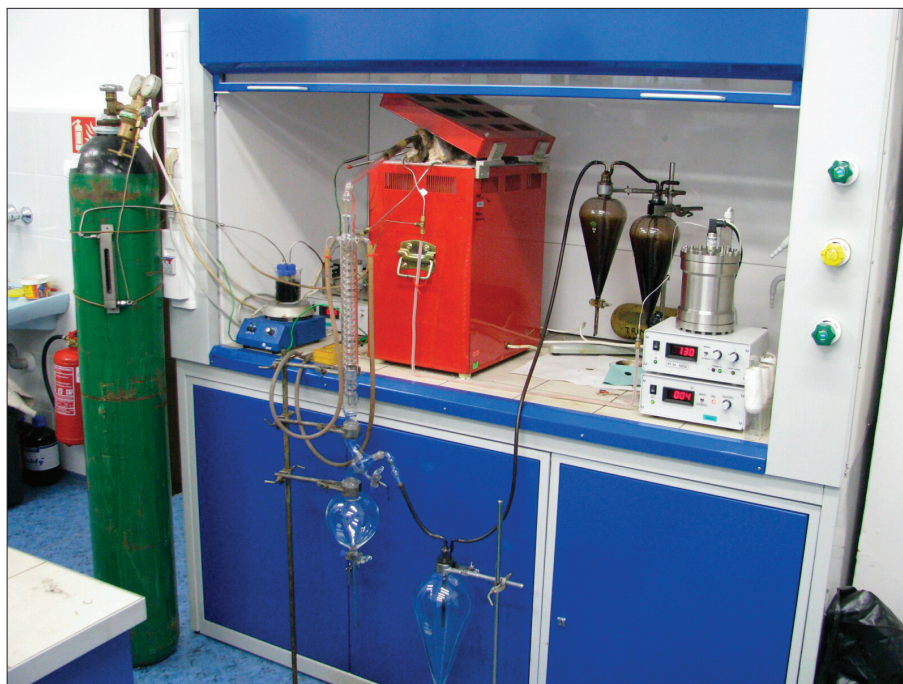
Obr. 3: Laboratorní pyrolýzní zařízení s možností odběru plynných vzorků.
