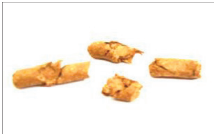
Obr. 3: Porušené brikety s patrnou kruhovou, plastickou deformací otisku pístu testeru.
