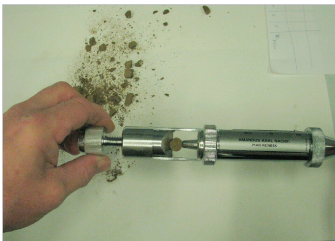
Obr. 3: Určení pevnosti pelety ručním testerem AK-14-E.
