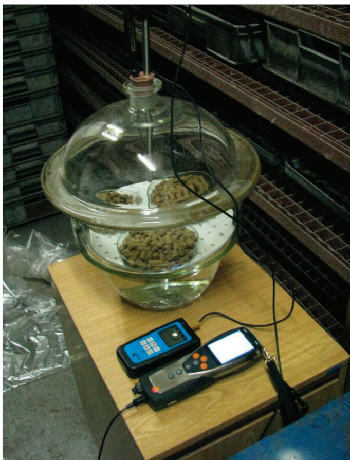
Obr. 1: Laboratorní zařízení pro stanovení nasákavosti pelet.
