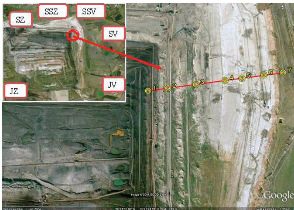
Obr. 1: Detail liniového rozmístění DT ve spádnici a celkový pohled na dobývací prostor dolu Nástup Tušimice s vyznačenými měřicími stanicemi v okolí, 19. 8. 2009.
