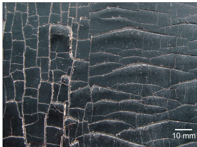
Obr. 1: Střed použitého pásu B-P z cementárny Ladce – horní krycí vrstva pásu.
