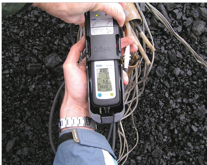
Obr. 4: Analýza majoritně zastoupených plynů pomocí analyzátoru Dräger. (Foto: Adamus)
