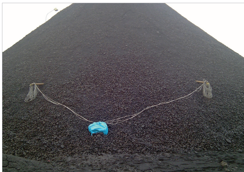
Obr. 3: Měření vnitřní teploty sondami s vyhodnocovací ústřednou.
