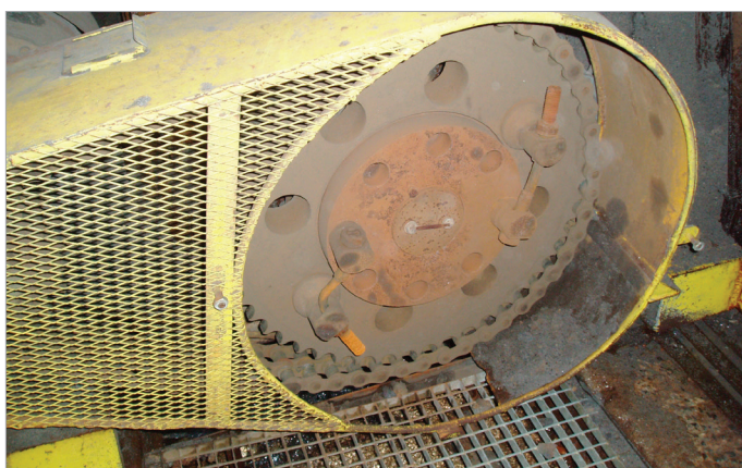
Obr. 7: Detail pojistné spojky.
