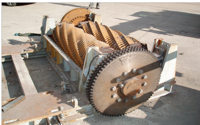
Obr. 16: Skládaný drticí válec.
