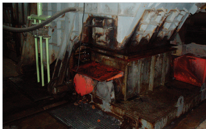
Obr. 2: Drtič strusky 15 t.h -1 .
