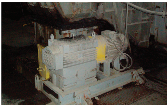
Obr. 1: Drtič strusky 15 t.h -1 .
