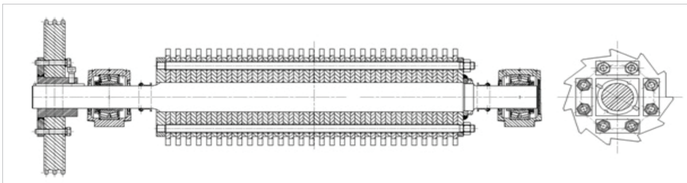
Obr. 15: Řez skládaným drticím válcem.
