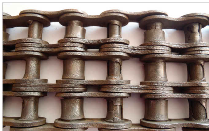
Obr. 28: Poškozený hnací řetěz drtiče DS500/40.
