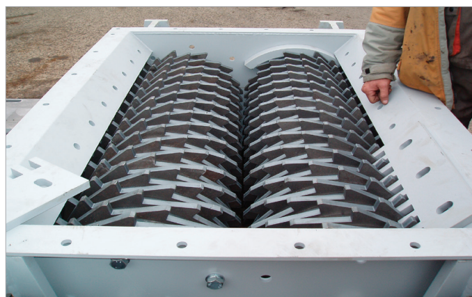
Obr. 17: Skládaný drticí válec.
