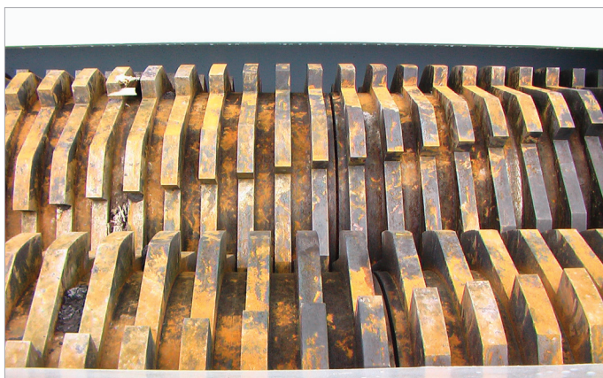
Obr. 11, 12: Dva pohledy na drticí válec s odlitým pláštěm.
