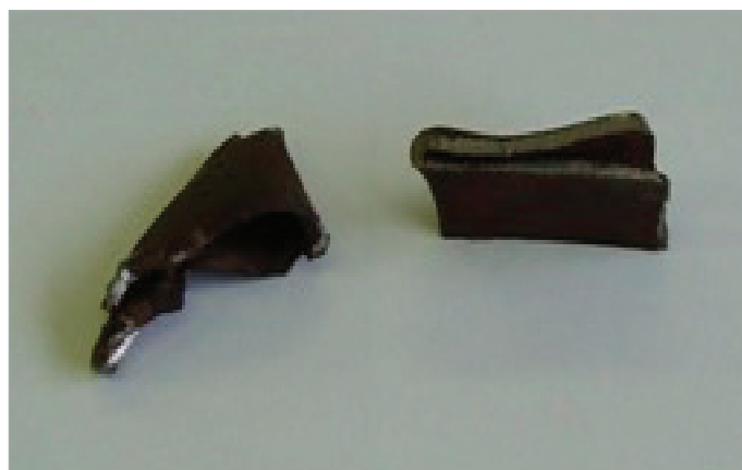
Obr. 21: Rozdrčená lešenářská trubka.
