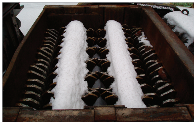
Obr. 4: Drtič strusky 15 t.h -1 - drticí válce.
