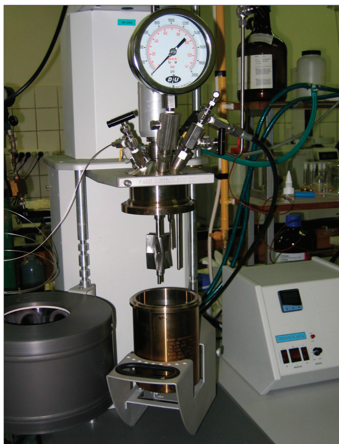
Obr. 1: Reaktor PARR použitý pro hydrokonverzi kapalných pyrolýzních produktů.
