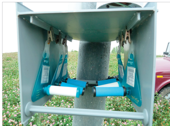
Obr. 5: Vzorkovací sestava Radiello pro vnější ovzduší.
