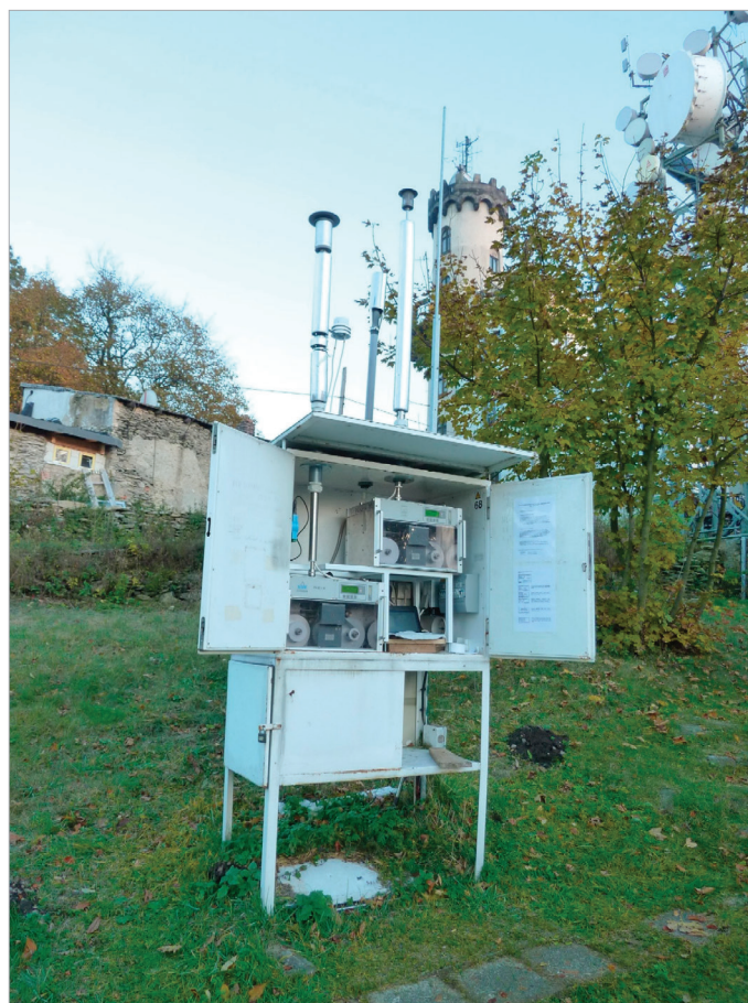
Obr. 6: Stanoviště pro kontinuální měření \text{PM}_{10} na Milešově.
