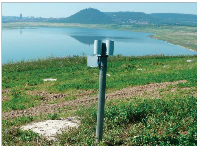
Obr. 4: Foto stativu s držáky vzorkovnic pro pasivní odběr plynů a prашného spadu.
