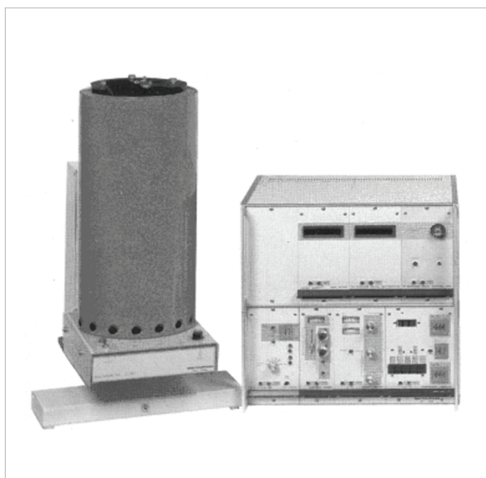
Obr. 2: Kalorimetr C80 včetně ovládací a měřicí jednotky.
