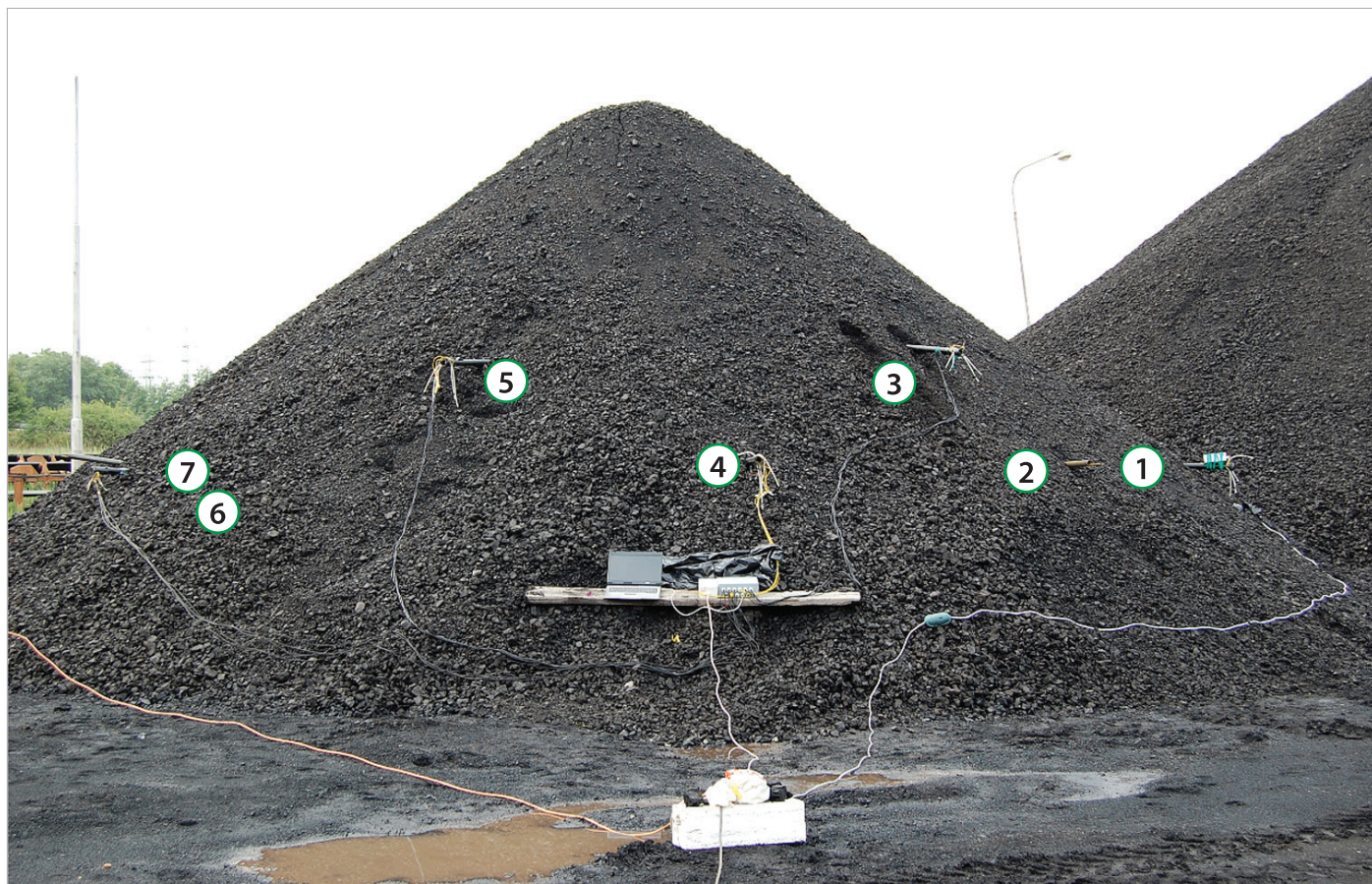
Obr. 1: Pokusná hromada č. III na depu Hrabák – zapuštěné měřicí sondy.
