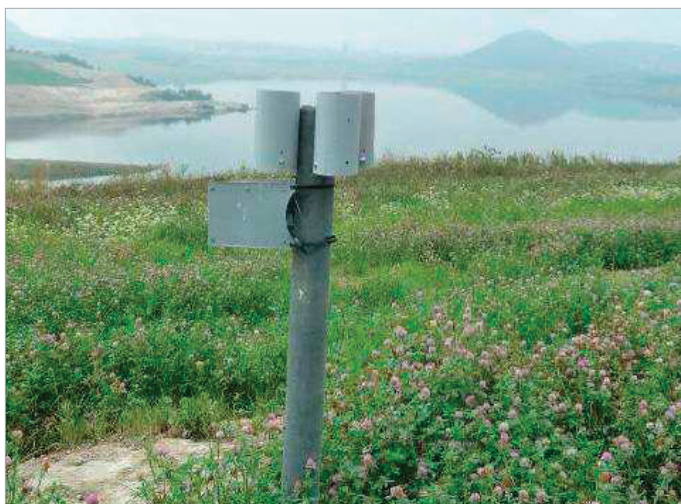
Obr. 2a: Foto stojanu s držáky vzorkovnic pro odběr prашného spadu.
