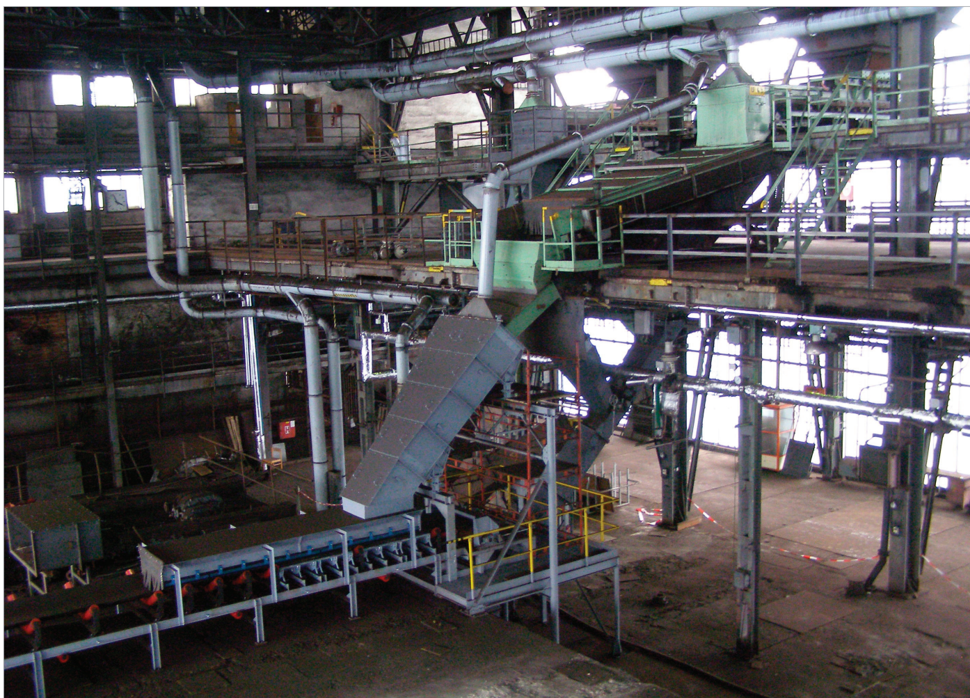
Obr. 3: Nový PD U10, včetně nového skluzu U5b na tento PD.
