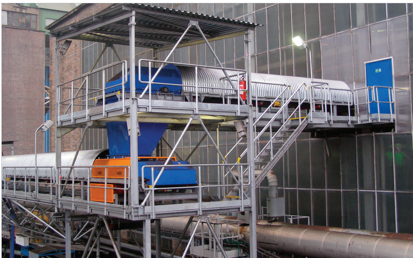
Obr. 5: Drtící linka na maloprodeji: nový PD B39a a navazující B39b.
