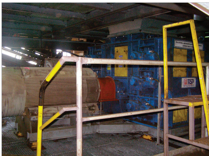
Obr. 1: Kladivový drtič s označením C10.
