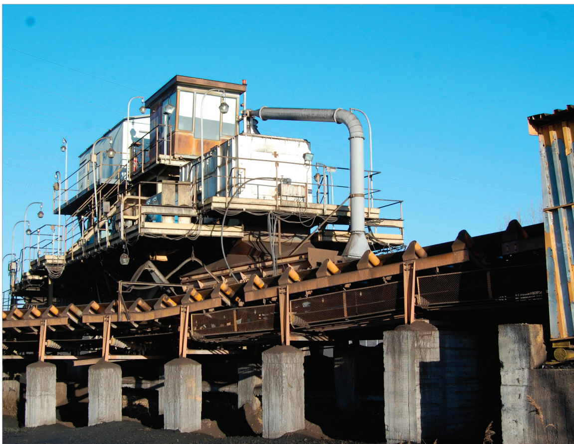
Obr. 6: Provedení krytu vratné stanice PD 148, krytu horního poháněcího bubnu a odsávání.
