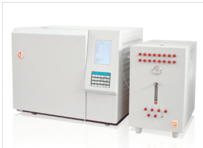
Obr. 1: Plynový chromatograf GC-4008B určený pro uhelné doly. [22]
