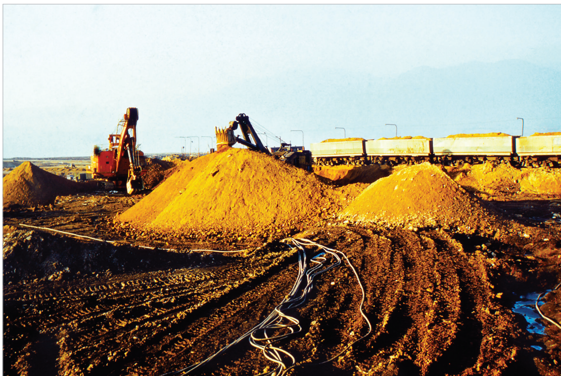
Obr. 11: Zakládání sutí na koruně koridoru ČSD-západ.
